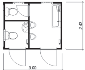
Typ TK 250 mit Polierabteil 2 Spülklosetts, 2 Pissoirs, 1 Waschrinne mit Kalt- und Warmwasser, 1 separates Polierabteil, elektrische Installation und Heizung.
