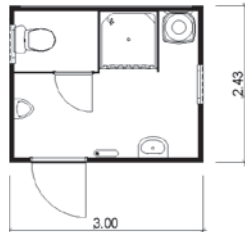
Typ TK 240 D 1 Toilettenabteil, 1 Pissior, 1 Duschkabine, 1 Waschbecken mit Warmwasser, 1 Boiler 80 l, im Weiteren wie Typ TK 240 WW.
