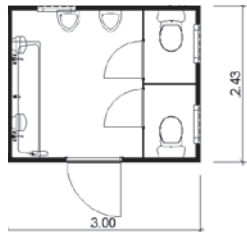
Typ TK 240 WW 2 Spülklosetts, 2 Pissoirs, 1 Waschrinne mit 1 Kalt- und 2 Warmwasserhähnen, elektrische Installation und Heizung.
