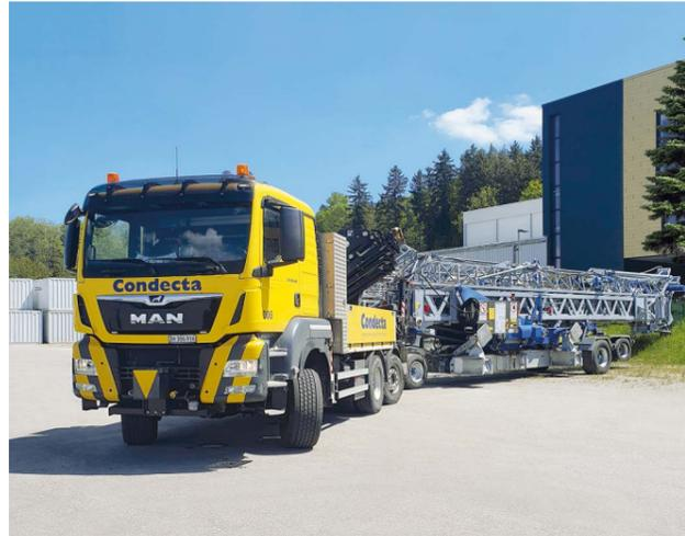
Der Schnelleinsatzkran EURO 4312 mit 43 Metern Ausladung für 5'000 Kilogramm Hauptlast besteht durch sein ruckfreies und präzises Arbeiten dank stufenlosen, elektronisch gesteuerten Frequenzumrichter-Antrieben bei maximalem Anlaufstrom von 40 Ampere sowie einer Hakenhöhe von 18 bis 30 Metern, die ohne Einbau von Turmelementen bis auf 24 Meter erhöht werden kann. Die kleinen Drehradien gewährleisten grosse Leistung auch bei kleinsten Platzverhältnissen.
